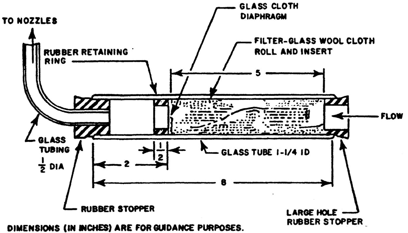
**FIGURE 509.3-1. SALT SOLUTION FILTER.**
