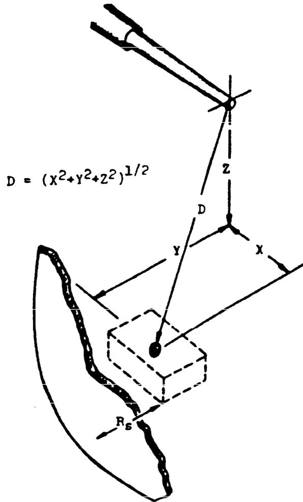
FIGURE 519.4-2. The distance parameter (D) and the depth parameter (R<sub>s</sub>).
