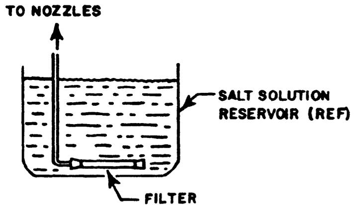
**FIGURE 509.3-2. LOCATION OF SALT SOLUTION FILTER.**
