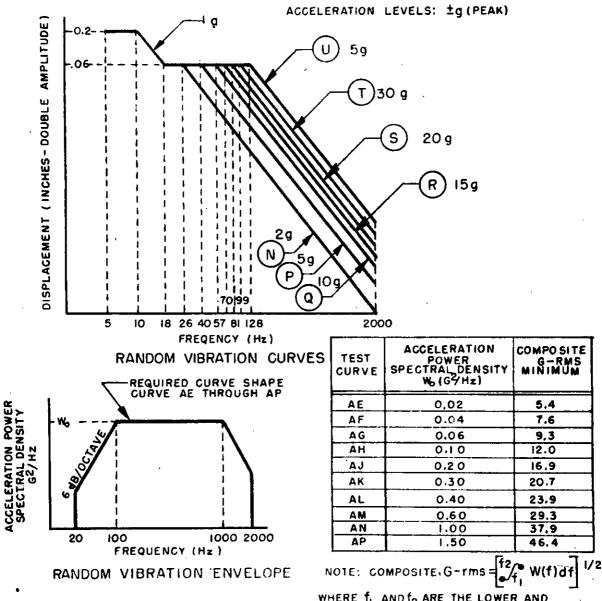
WHERE  $f_1$  AND  $f_2$  ARE THE LOWER AND UPPER TEST FREQUENCY LIMITS RESPECTIVELY W(f) IS THE ACCELERATION POWER SPECTRAL DENSITY IN G<sup>2</sup>/Hz UNITS
